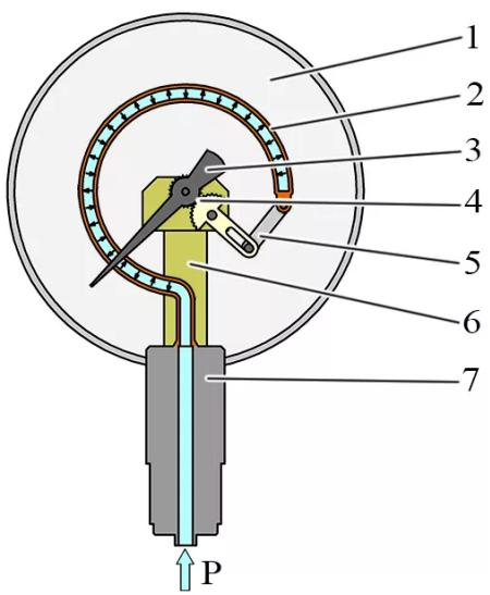
Основу прибора составляет медная изогнутая пружинная трубка овального сечения (трубка Бурдона) (поз.2).
